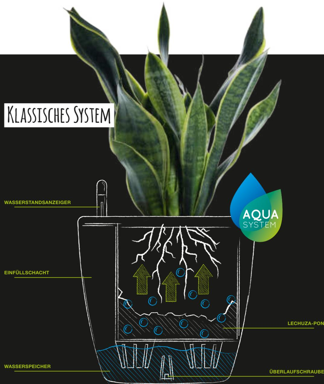
Das klassische Bewässerungssystem kommt bei den größeren LECHUZA-Pflanzgefäßen zum Einsatz. Es besteht aus dem eigentlichen Pflanzgefäß, einem Pflanzeinsatz oder Trennboden und den Bestandteilen des Bewässerungssets: Füllschacht, Wasserstandsanzeiger und LECHUZA-PON als Drainageschicht. Eine Überlaufschraube verhindert im Freien, dass sich Stauansätze bilden.
